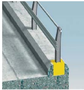
Фиксация рельс и стоек
